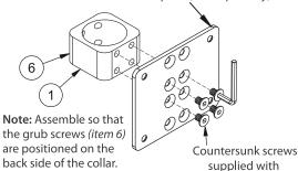
2. SLIDE COLLAR ONTO A Ø50MM POLE
